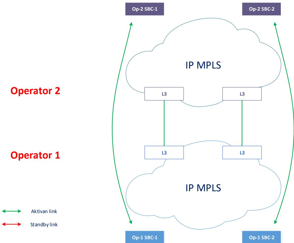
Detekcija ispada i zaštitno usmjeravanje ostvaruje se na aplikacijskom sloju tj na SIP razini. Ovisno o potrebama operatora i bilateralnom dogovoru između operatora, detekciju ispada i zaštitno usmjeravanje moguće je ostvariti i na IP sloju.
