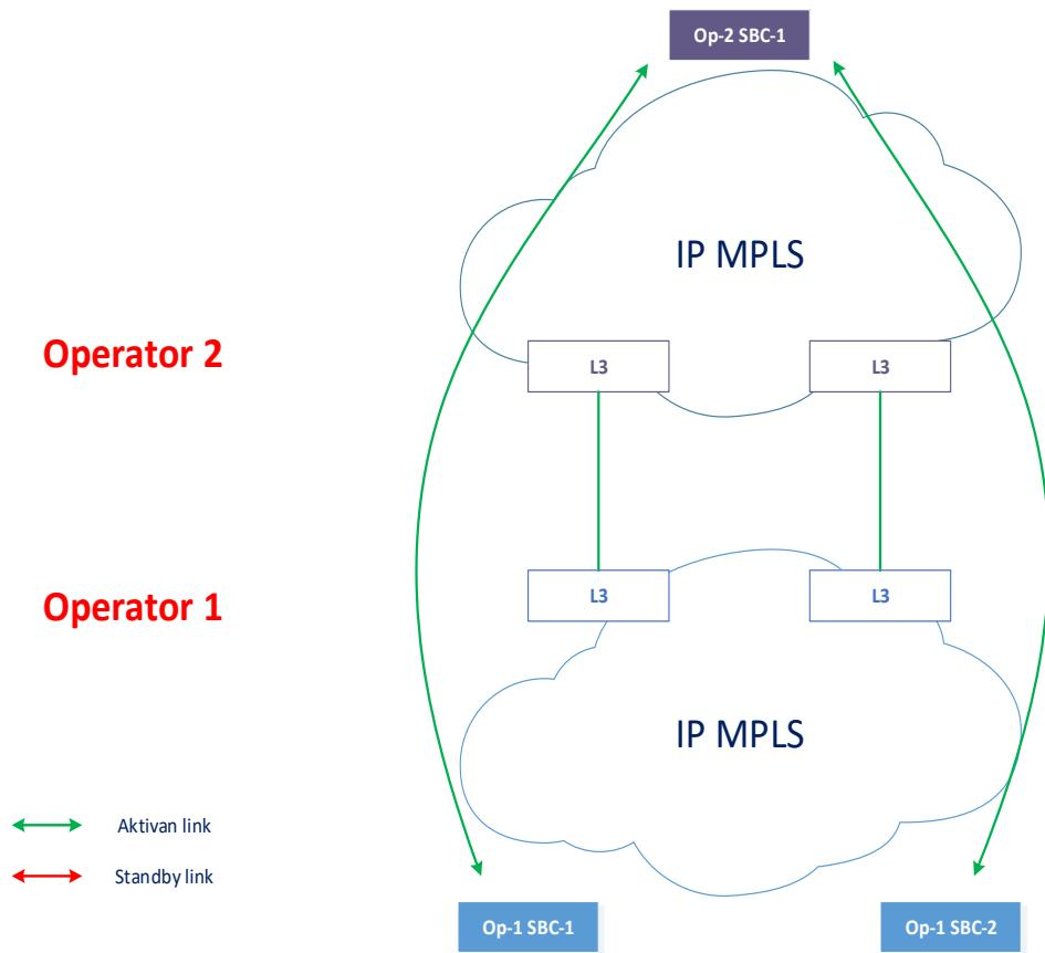
Operatori uspostavljaju dva aktivna SIP linka koji rade u *load balancing* načinu rada, pri čemu u slučaju ispada jednog linka, drugi preuzima potpunu razmjenu prometa između operatora. Detekcija ispada i zaštitno usmjeravanje ostvaruje se na aplikacijskom slojutj na SIP razini. Ovisno o potrebama operatora i bilateralnom dogovoru između operatora, detekciju i zaštitno usmjeravanje moguće je ostvariti i na IP sloju.
