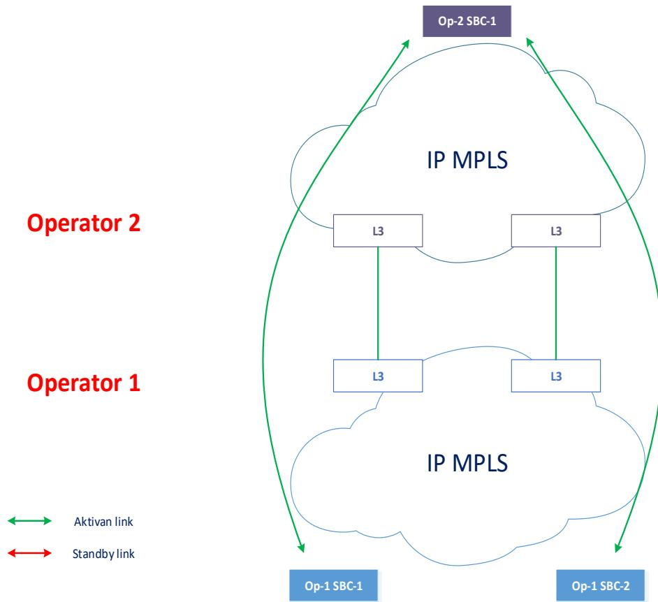
Operatori uspostavljaju dva aktivna SIP linka koji rade u *load balancing* načinu rada, pri čemu u slučaju ispada jednog linka, drugi preuzima potpunu razmjenu prometa između operatora. Detekcija ispada i zaštitno usmjeravanje ostvaruje se na aplikacijskom sloju tj na SIP razini. Ovisno o potrebama operatora i bilateralnom dogovoru između operatora, detekciju ispada i zaštitno usmjeravanje moguće je ostvariti i na IP sloju.
