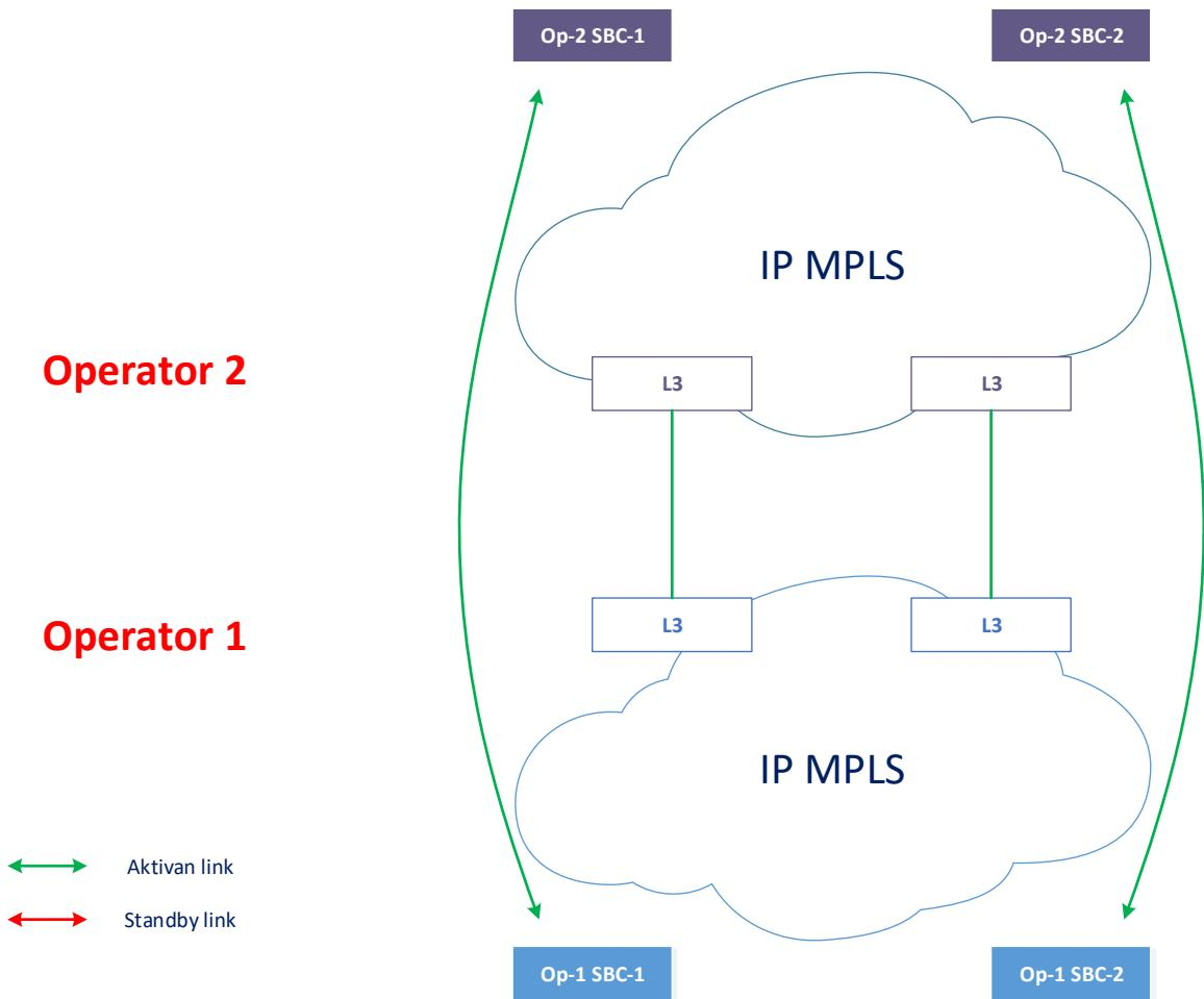
Detekcija ispada i zaštitno usmjeravanje ostvaruje se na aplikacijskom sloju tj na SIP razini. Ovisno o potrebama operadora i bilateralnom dogovoru između operatora, detekciju ispada i zaštitno usmjeravanje moguće je ostvariti i na IP sloju.
