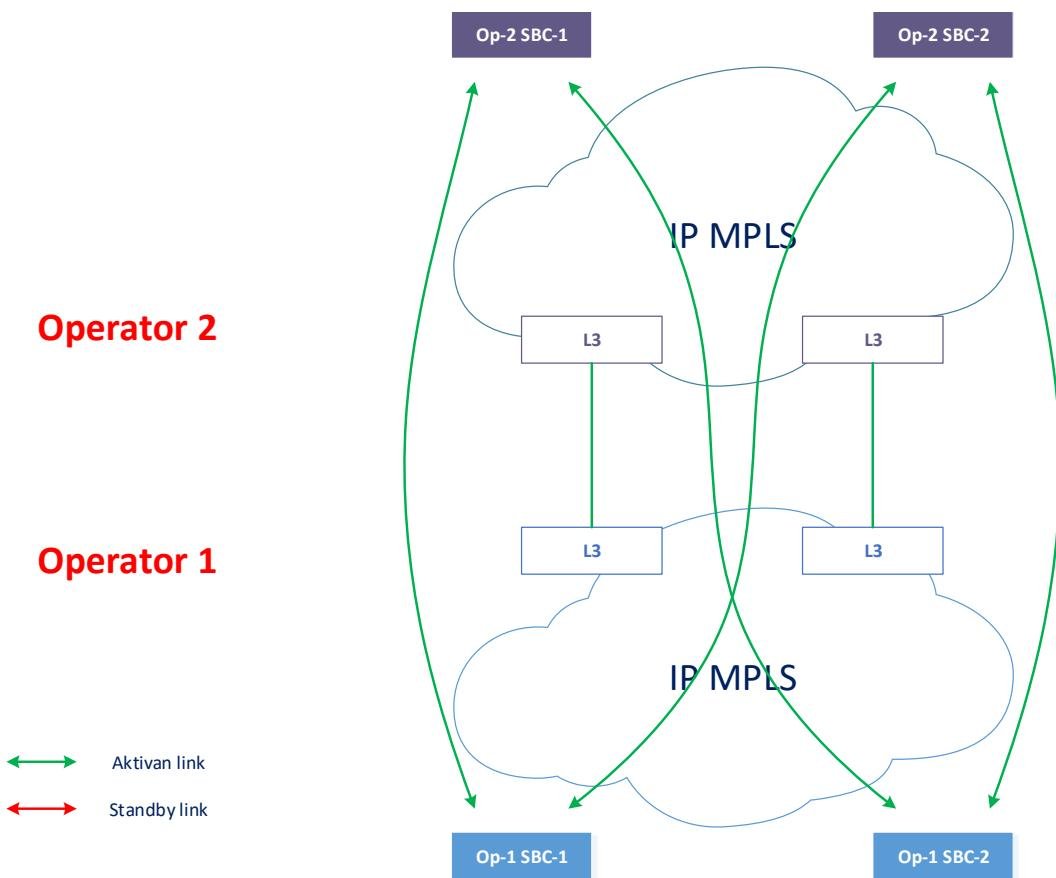
Operatori uspostavljaju četiri aktivna SIP linka koji rade u *load balancing* načinu rada, pri čemu u slučaju ispada jednog linka, preostali preuzimaju potpunu razmjenu prometa između operatora. Ovisno o potrebama operatora i bilateralnom dogovoru između operatora, alternativno je moguće ostvariti povezivanje putem dva aktivna SIP koji rade u *load balancing* načinu rada, pri čemu u slučaju ispada jednog linka, drugi preuzima potpunu razmjenu prometa između operatora.
